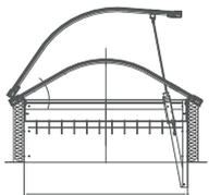
Seitenansicht eines Lichtbandes mit Zahnstangenantrieb und Absturzgitter
